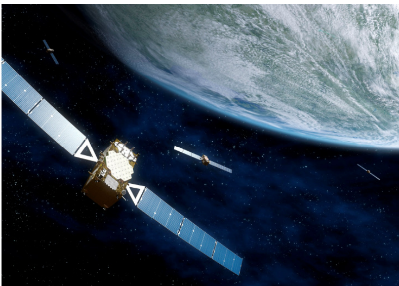
Bild: Galileo wird auf 30 Satelliten basieren, die in einer Höhe von etwa 23.000 km die Erde umkreisen. Am Boden wird ein Netz von Stationen eingerichtet werden, die die Satelliten kontrollieren.
